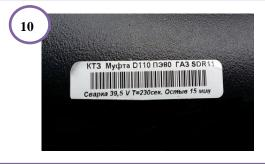
10. Используйте сканирование штрих-кода на муфте или ручной способ ввода параметров сварочного процесса. Запустите сварку.
