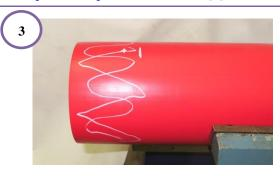
3. Снимите оксидный слой, используя для этого специальные механические зачистные устройства или ручной скребок.
