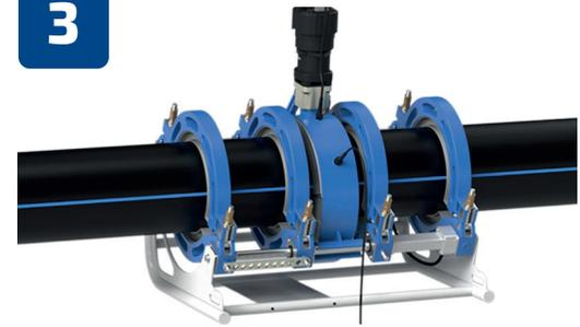
В аппарат устанавливается торцеватель, соприкасающиеся поверхности труб обрабатываются, торцеватель убирается и производится регулировка смещения кромок труб (норма – меньше 10% толщины стенки). После регулировки смещения при необходимости производится дополнительное торцевание.
